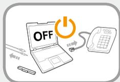
在升级计算机之前，请确保首先关闭计算机电源，然后断开所有连接的线缆。如果笔记本电脑具有外部类型（可拆除）电池，也请卸下电池。
