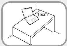
计算机与墙体之间的距离不得低于15 厘米，之间不得放置任何物体。这样可能会造成计算机散热不良内部温度过高，继而导致系统运行不稳定甚至停止工作。
