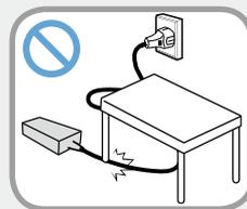
不要在电源线或交流电适配器上放置重物或者用脚踩，以免损坏电源线或交流电适配器。
