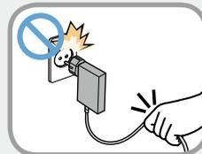
如果通过拖拽电缆来拔出适配器，可能会导致适配器损坏，因而引发触电、爆炸声或电火花。
